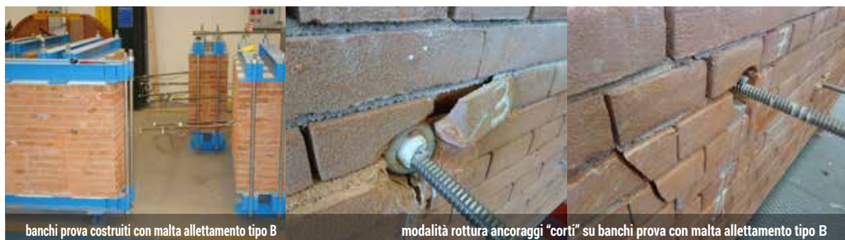
banchi prova costruiti con malta allettamento tipo B
