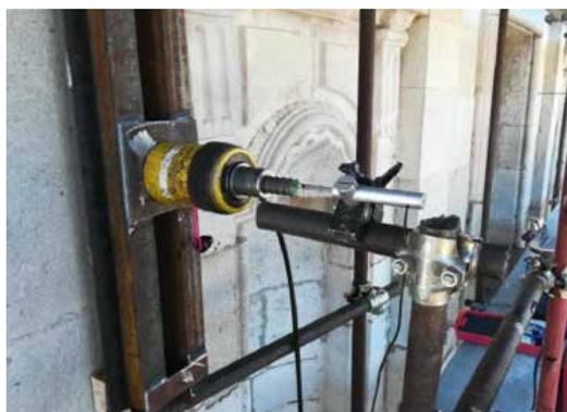
1. Prove di estrazione non confinate eseguite con controllo di carico e spostamento sul paramento interno. Ancoraggi test tipo GBOS 12-40 P con lunghezza complessiva di 1,50 m, attrezzati con calza in corrispondenza del solo paramento interno (lunghezza effettiva ancoraggio 0,75 m). Carichi di trazione applicati fino a 45 kN.
