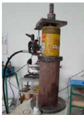
2 Prove di sfilamento su conci in pietra con caratteristiche simili a quelle degli elementi in opera sul paramento esterno. Ancoraggi test tipo GBOS 12-40 P con lunghezza effettiva di ancoraggio pari a 170-180 mm. Carichi massimi di trazione applicati confrontabili con quelli ottenuti dalle prove sul paramento interno.
