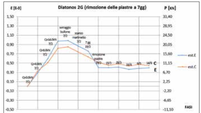
Diatonos a 7 gg grafico della deformazione nella sezione centrale C e nelle sezioni di estremità E nelle diverse fasi
