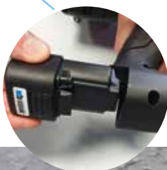
Batteria Battery Batterie Batterie 2,50 Ah 7,2 V Li-ion
